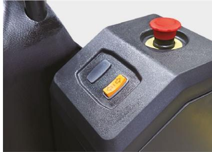
Equipé de série de boutons marche AV/AR et levée/descente de chaque côté du préparateur de commande. L'opérateur n'a pas besoin de monter et descendre du poste de conduite pour faire fonctionner le chariot. Cela améliore considérablement l'efficacité de la préparation de commandes et la sécurité des opérations.
