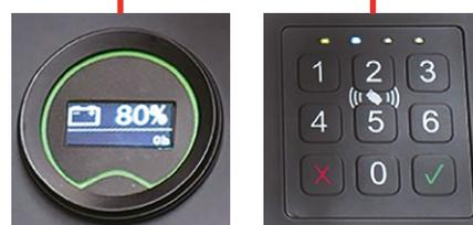
Le dispositif multifonctionnel du panneau de commande affiche l'état de service de l'appareil, le temps d'utilisation, l'état de charge de la batterie, la vitesse de conduite et l'angle de braquage.
