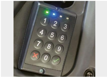
Panneau de contrôle d'accès par code PIN ou par lecteur de carte RFID en option. Cette fonction simplifie grandement le processus d'autorisation notamment lorsque plusieurs opérateurs peuvent utiliser l'appareil.
