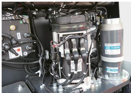
Un moteur puissant à courant alternatif conçu et fabriqué par Schabmüller. Vitesse allant jusqu'à 8km/h, le réducteur est fabriqué par Kordel. De plus, les roues motrices Rader Vogel importées d'Allemagne contribuent à la durée de vie du bloc moteur.
