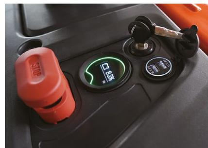
Le dispositif multifonctionnel peut afficher l'état de service de l'appareil, le temps d'utilisation, l'état de charge de la batterie, la vitesse de conduite et l'angle de braquage.
