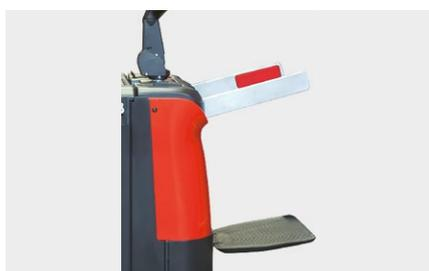
La plateforme et les bras de protection rabattables ainsi que la nouvelle structure interne du châssis permettent de réduire au maximum la longueur totale du gerbeur et d'obtenir un rayon de braquage plus réduit. En outre, la structure sur amortisseur de la plateforme autoportante rend les opérations plus confortables.
